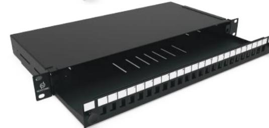
Patch Panel Extraible con 12 puertos para acopladores SC Duplex / LC Quad en 1RU (Vacio)
