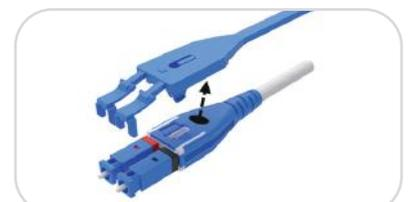
**SCHRITT 2:** Ziehen Sie den Riegel heraus von Uniboot
